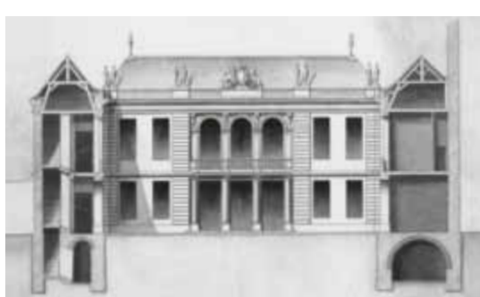
Aus der Planserie zum spätbarocken Neubau. Hoffassade des Hinterhauses und Schnitt durch die Hofflügel.
