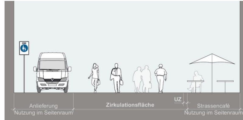
Beispiel Querschnitt einer Fussgängerzone in der Innenstadt.
