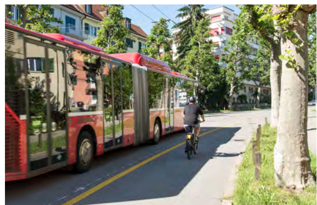
Aufgrund Steigung: Markierung eines Radstreifen anstelle Umweltspur, damit kann ein gefahrloses Überholen gewährleistet werden.
