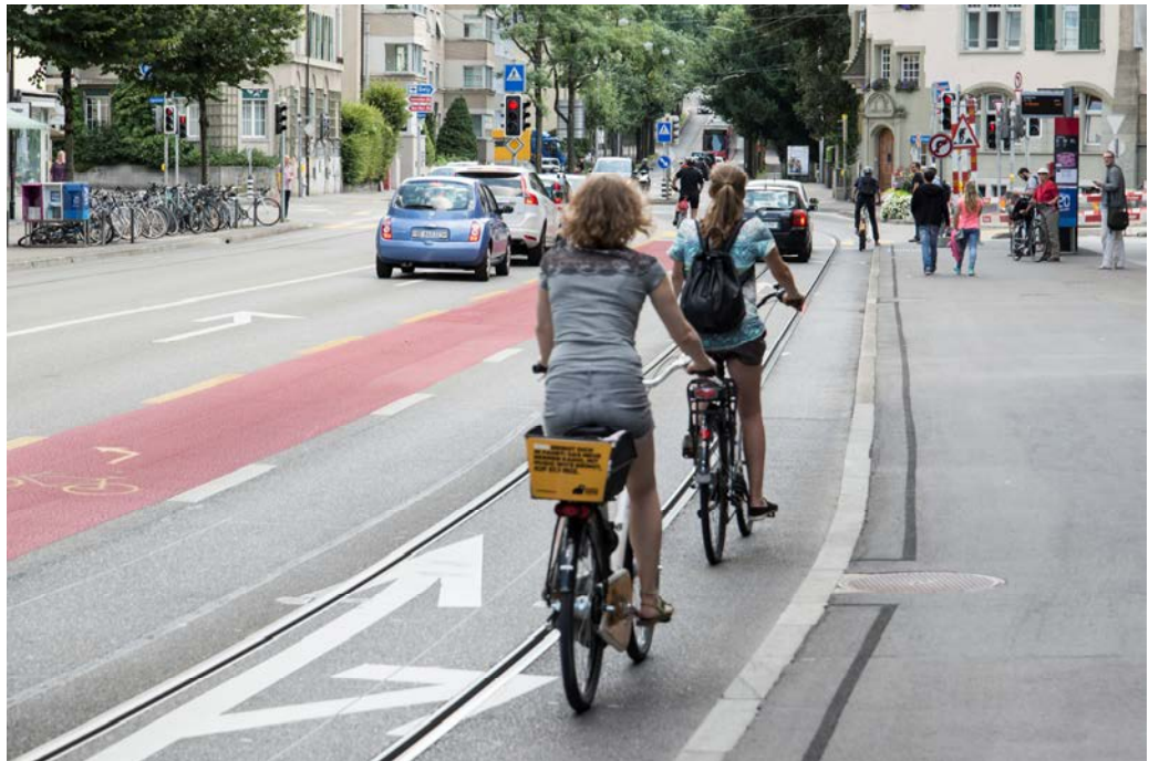
Kaphaltestelle Sulgenau, Monbijoustrasse: Die enge Durchfahrt zwischen der Haltekante und den Gleisen stellt eine Gefahrenstelle dar, im Besonderen mit Cargo-Bike oder Veloanhänger.
