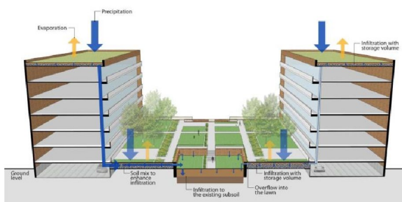
Prinzip «Schwammstadt» (Quelle: www.sieker.de )
