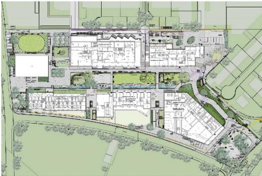
Ausschnitt Situationsplan Aussenraum (inkl. Gründächer mit Fotovoltaik und Versickerungsanlagen, Retention und Ziergewässer)<sup>1</sup>
