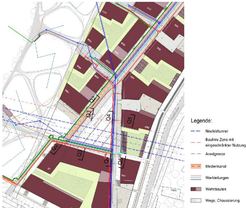
Abbildung 16: Situation mit Lage der Querprofile (Quelle Konzept Absicherung von Bauten in der Zone mit eingeschränkter Nutzung (Neufeldtunnel), Rothpletz, und Lienhard)
