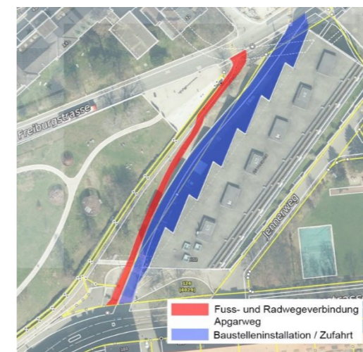
Abbildung 2: Gebaute Wegeverbindung Apgarweg, Baustelleninstallation und -zufahrt – Lage in Luftbild
