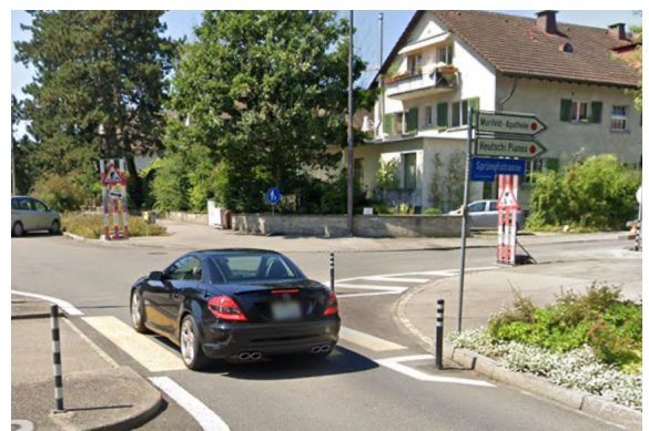
Die provisorische Umsetzung an der Egghölzlistrasse zeigt die Restflächen auf, welche dem Fussverkehr zugeschlagen werden können. Hinweis: im Sinne der Hindernisfreiheit ist immer die bauliche Umsetzung anzustreben.
