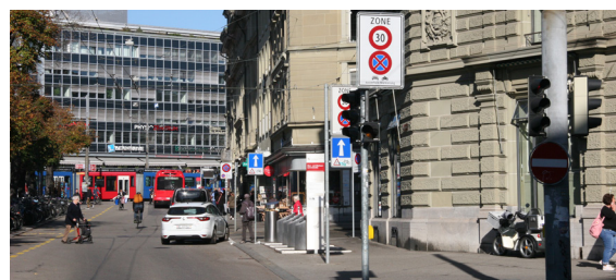
Ausstattungen wie Signale, Signalgeber, Masten, Signaletik, Kandelaber, Abfallkübel, Parkuhren, Hydranten, Stromkästen, Kleinbauten, Plakatierung und temporäre Infotafeln, Unterflursammelstellen etc → Auf einem «Möblierungsstreifen» konzentrieren, Zusammenfassen, bei Platzmangel ausserhalb Trottoir platzieren.
