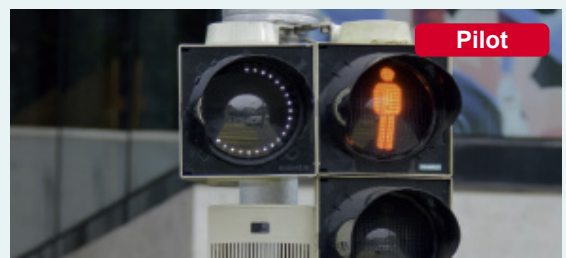
Der Kreis aus LED-Lichter zeigt an, wie lange es noch dauert, bis die Ampel von Rot auf Grün wechselt.
